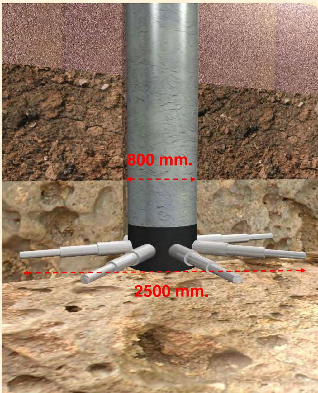
I pistoni metallici, in acciaio Fe 510, hanno uno sviluppo notevole, tant'è che in un palo Ø 800 mm il diametro finale raggiunge e supera i 2500 mm.
