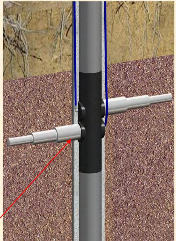
**I pistoni hanno una forza di penetrazione notevolissima che consente l'elongazione in qualsiasi tipo di terreno . La pressione nel sistema TFEG® varia dai 350 fino ai 700 Bar.**
